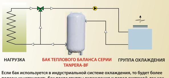
полезным установить бак после группы охлаждения и перед системой, так как основной целью здесь является более точный контроль температуры уходящей воды.
